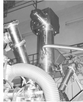
图 2 晶体谱仪在阳加速器上的配置图
